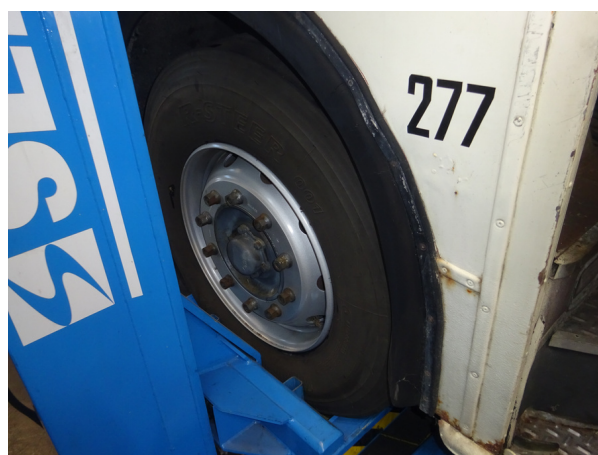
Les nouveaux pneus installés sur les nouvelles jantes.
