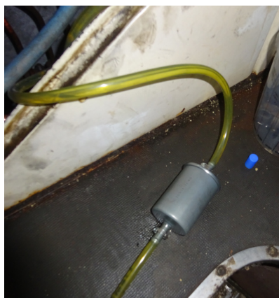
Le filtre à gazoil en parallèle à la nourrice.
