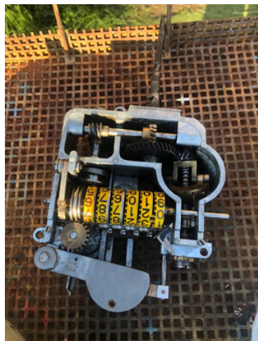
Démontage, sablage et peinture du bloc. Le système mécanique est actuellement en cours de rénovation.
