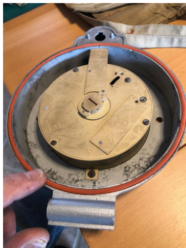
Démontage, sablage et peinture du bloc. Le système mécanique est actuellement en cours de rénovation.
