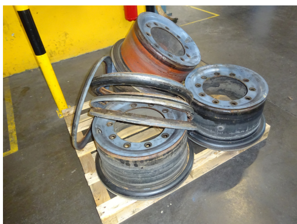
Dépose des anciennes jantes à cerceaux.
