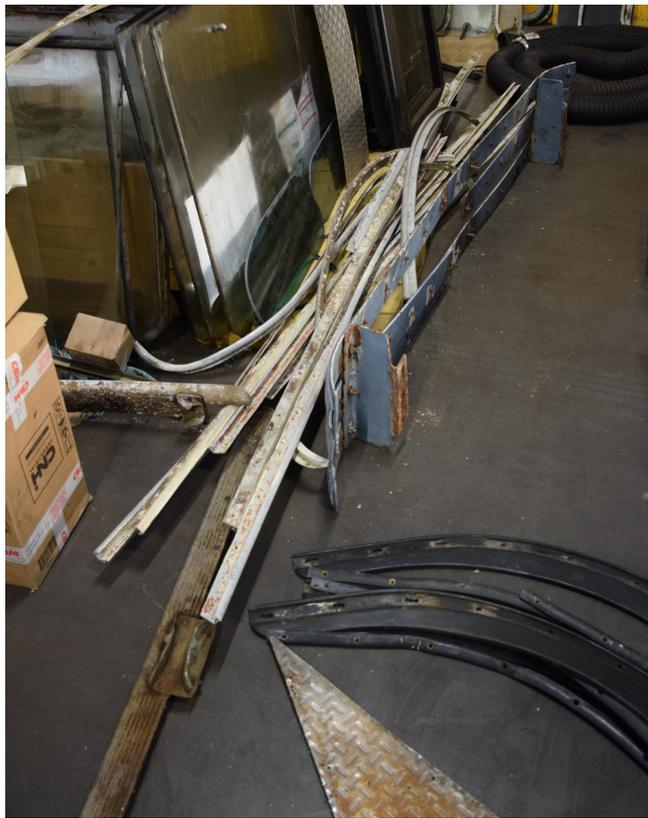
Les gouttières en aluminium seront redressées et poncées. Les baguettes intérieures, droites ou arrondies remplaceront celles corrodées. Elles proviennent également du véhicule donneur de Moissac, stocké à l'abri et donc épargné de la rouille.
