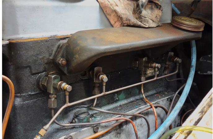
Les quatre injecteurs, démontés pour leur tarage. Une fois l'opération réalisée, ils sont remis en place sur le moteur.
