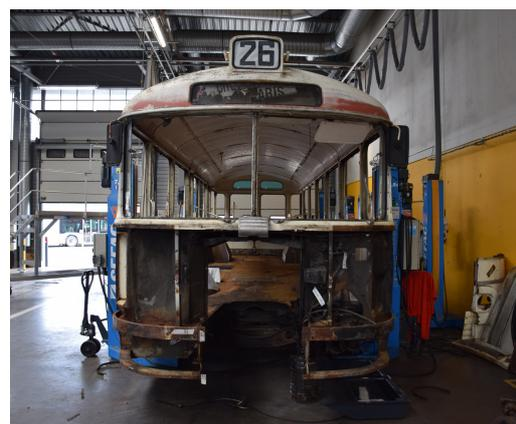
Le démontage du radiateur permet de retirer le moteur plus facilement. Il y a de la place à l'avant !
