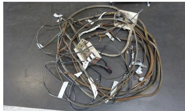
L'un des faisceaux électriques du véhicule. Il s'agit ici des commandes de portes de la cabine du receveur.
