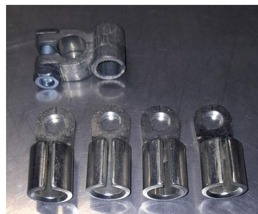
Confection d'un nouveau câble électrique avec soudure de la connectique.
