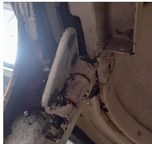
Dépose des portes. Les charnières devront être remplacées.
